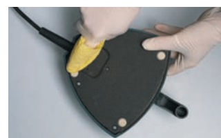
Reinigen Sie die Gummifüße unter dem Fussanlasser regelmäßig mit Reinigungsbenzin.
