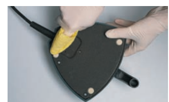
Reinigen Sie die Gummifüße unter dem Fussanlasser regelmäßig mit Reinigungsbenzin.
